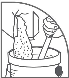
En 7.5 a 8.5 litros de agua agregue gradualmente un saco de 40 kg de Adeblok Repello Fino y mezcle hasta obtener una pasta suave y libre de grumos. Espere 10 minutos antes de usar la mezcla. Sin agregar más agua vuelva a mezclar para usar.
