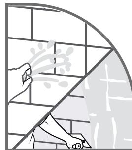
Humedecer la superficie donde se vaya a colocar la pasta de Adeblok Repello Fino. Con una llana metálica cuadrada esparcir el material con movimientos hacia arriba y de izquierda a derecha formando una cruz.
