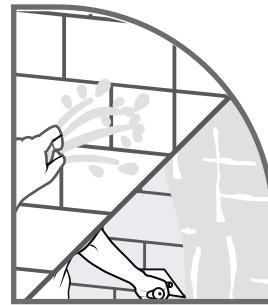
Humedecer la superficie donde se vaya a colocar la pasta de Adeblok Repello Grueso. Con una llana metálica cuadrada espacer el material con movimientos hacia arriba y de izquierda a derecha formando una cruz.
