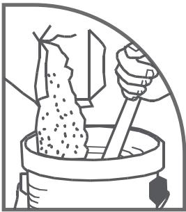
En 7 a 8 litros de agua agregue gradualmente un saco de 40 kg de Adeblok Repello Grueso y mezcle hasta obtener una pasta suave y libre de grumos. Espere 10 minutos antes de usar la mezcla. Sin agregar más agua vuelva a mezclar para usar.
